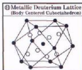
Рис. 12. Формирование конденсированного состояния – кристаллической решетки металлического дейтерия, имеющей объемно-центрированную кубооктаэдральную структуру ( 14 = 8 + 6 поверхностей). Черный круг (●) соответствует грани октаэдра. На каждой такой грани может находиться от 1 до 4 атомов дейтерия (этот случай мы назовем окта-сосудом). Грани тетраэдра обозначены белыми кругами (○). Каждая грань такого тетра-сосуда может принять не более 1 атома дейтерия, и удерживает его там с трудом. См. фото на рис. 11.
