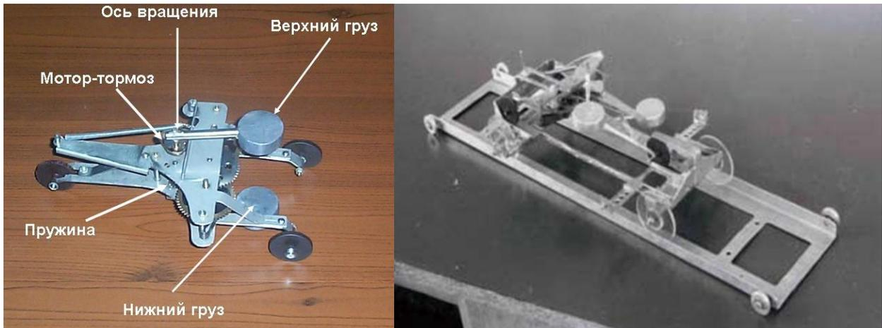
Рис. 1. а) Пружинный инерциоид Толчина; б) Инерциоид на демпферной и индикаторной тележках.
